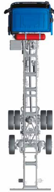
CNG – za kabinou
